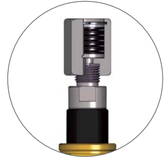
작동 후 (Spool의 누름에 의해 Seal 기능이 해제됨)
